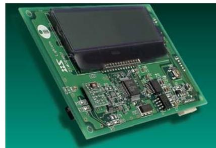
図 1 紫外線センサモジュールの外観図
